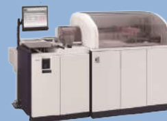
LABOSPECT 006全自动生化分析仪 •测定速度： 最高1900测试/小时
